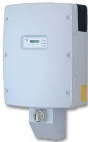
Fig. 1.11 – Inversor de 5.000 W. Na parte inferior um dispositivo para desconectar a entrada CC.
