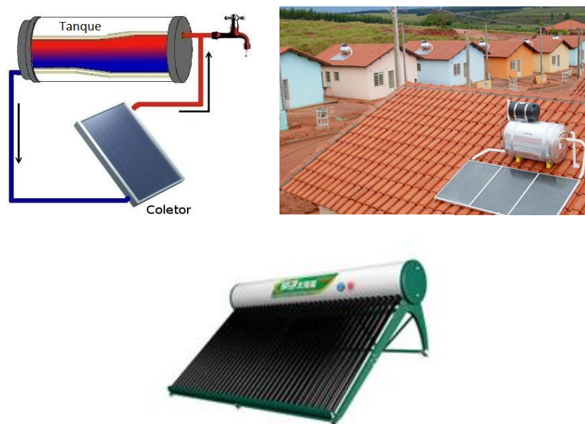
Fig. 1.5 – Esquerda: o aquecimento solar baseia-se na convecção natural da água. Direita: emprego de coletores planos num conjunto habitacional no Brasil. Abaixo, sistema mais popular na China com o coletor plano sendo substituído por tubos de vidro evacuados, mais adequados a climas temperados.
