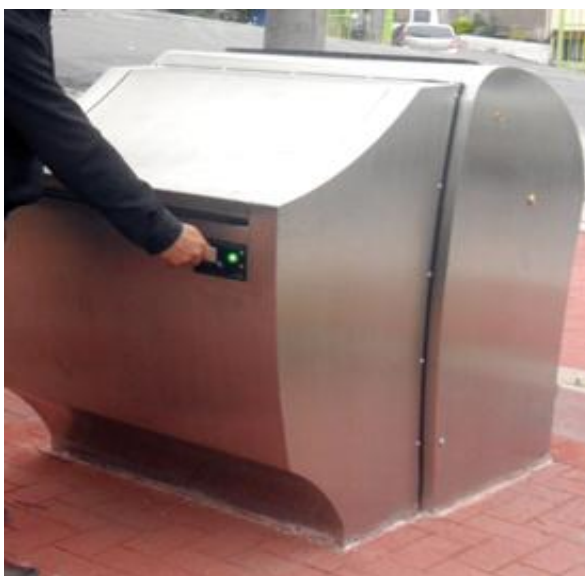
Foto: acionamento por cartão RFID da câmara de recepção de bigtainer em Pirituba / Jaraguá
