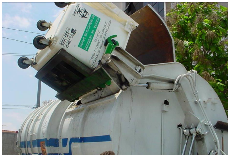
Foto: veículo CHL, coletor de contêineres de Grandes Geradores de RSSS
