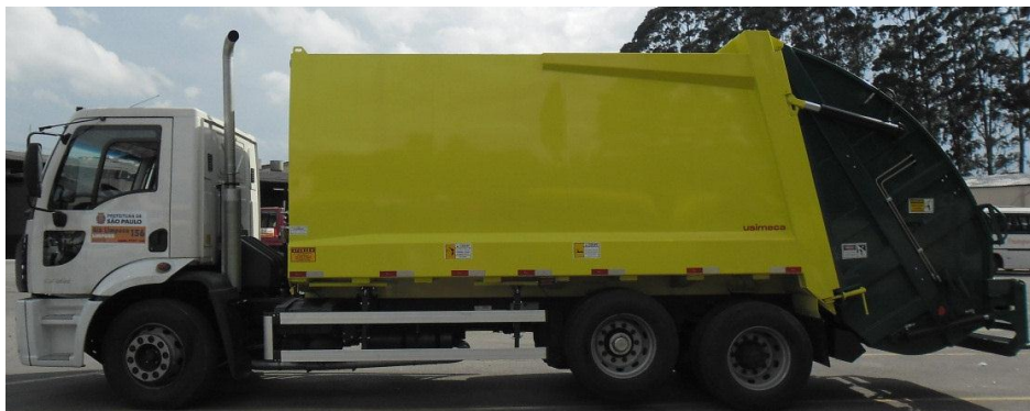
Foto: veículo compactador com lifter para coleta dos resíduos de varrição
