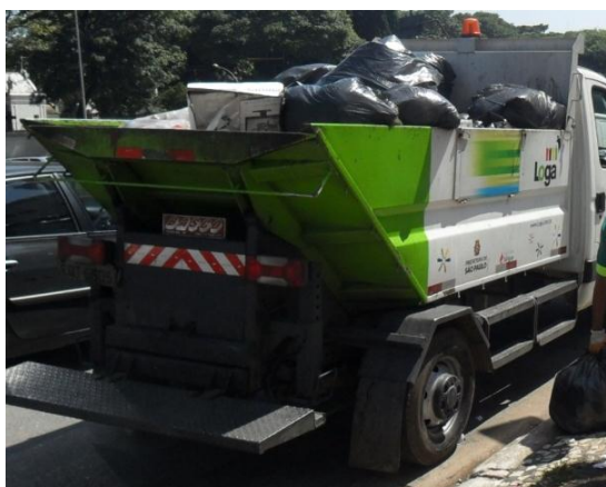
Foto: veículo coletor de pequeno porte para ZMRC e coletas auxiliares
