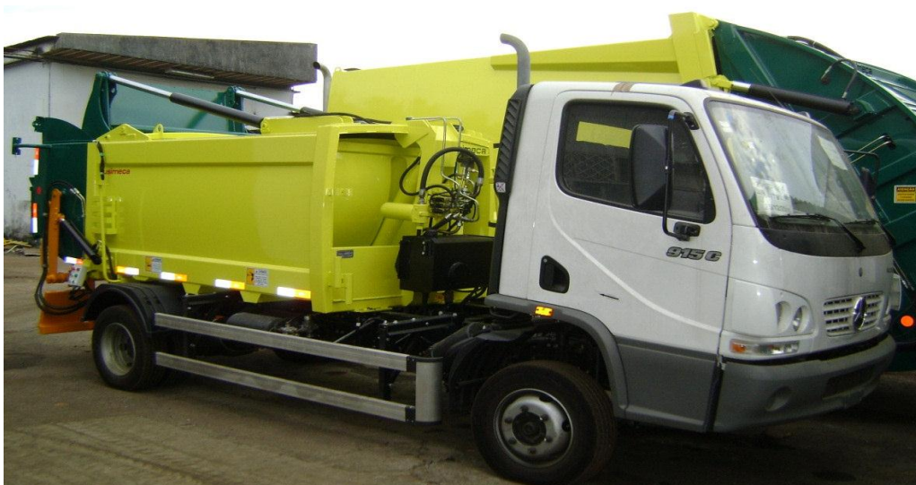
Foto: veículo coletor compactador para uso em vias de acesso restrito
