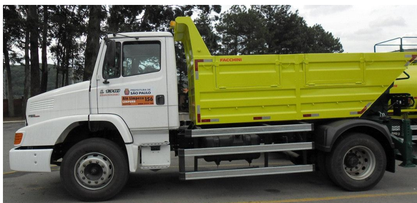
Foto: veículo basculante compacto para apoio à coleta e transbordo de resíduos
