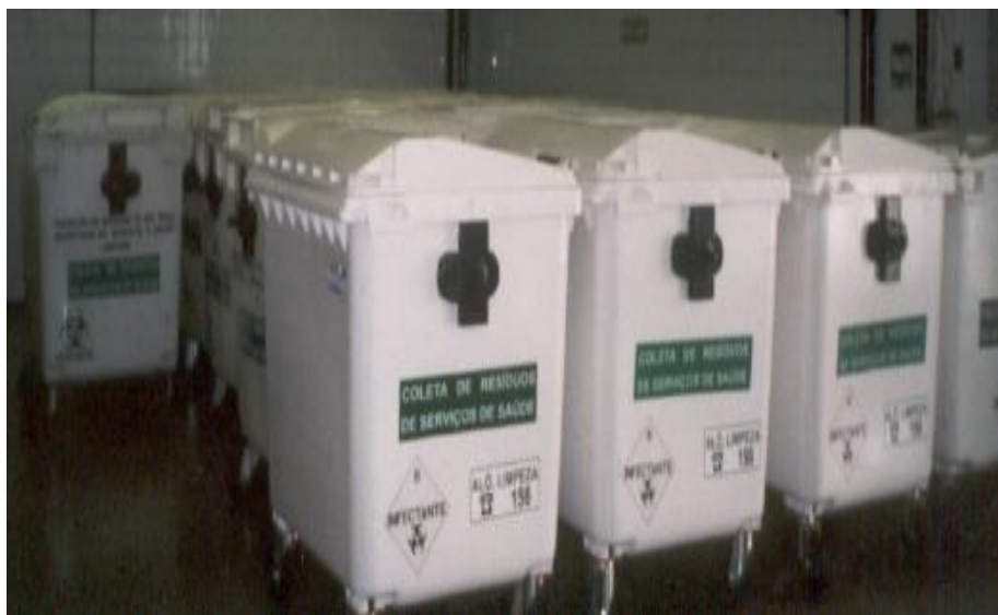
Foto: Armazenamento externo - Resíduos do Grupo A: Pequenos Geradores
