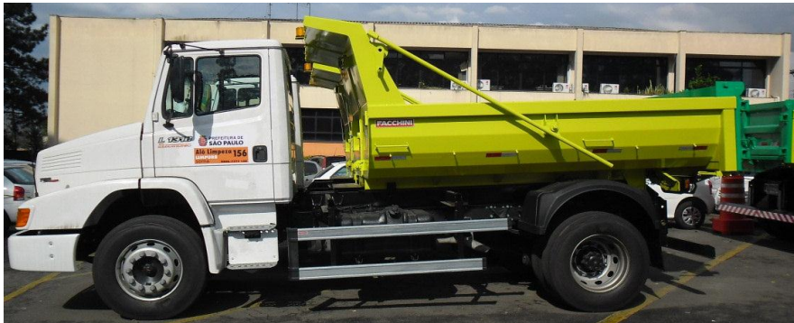
Foto: veículo basculante compacto de caçamba baixa para coleta manual de resíduos de bocas de lobo e bueiros
