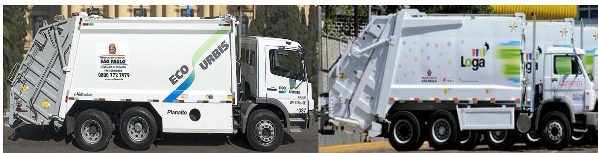
Foto: caminhões coletores/compactadores dotados de “Lifter”
