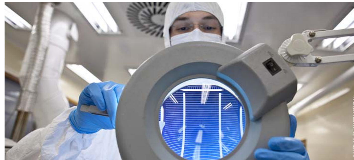
imagem CIENTISTA MANIPULANDO LÂMINAS DE SILÍCIO DURANTE PROCESSO DE METALIZAÇÃO NO LABORATÓRIO DE CÉLULAS SOLARES DO NÚCLEO TECNOLÓGICO DE ENERGIA SOLAR DA PUC-RS / PORTO ALEGRE - RIO GRANDE DO SUL.
